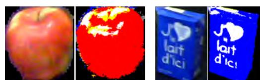
FIGURE 11 – Illustration de la perception des couleurs de deux objets par le robot.
